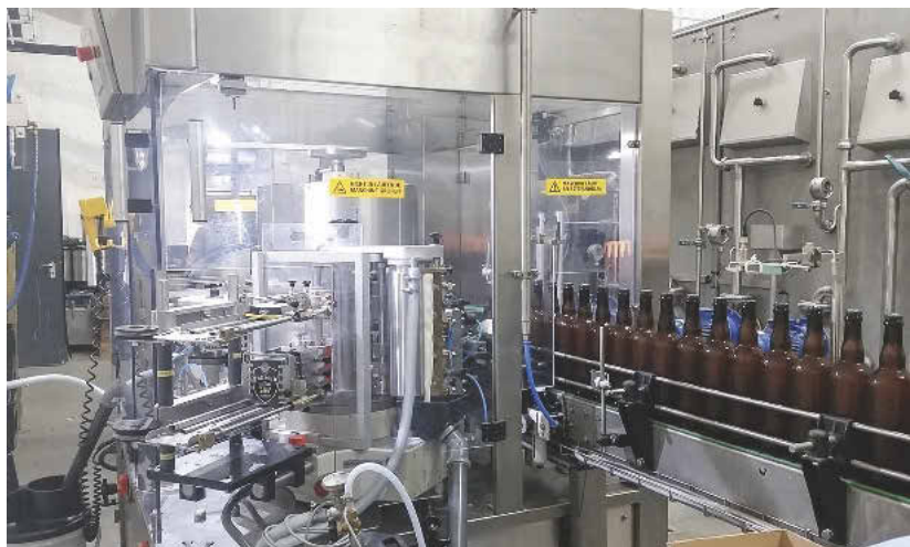
Die Kaltleim-Etikettiermaschine Labetta von Gernep etikettiert bis zu 3000 Flaschen pro Stunde
