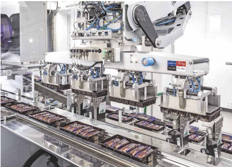
Eine Besonderheit des Flowmoduls besteht darin, dass es damit möglich ist, sowohl einzelne Produkte in unterschiedlicher Anzahl, als auch Produkte in Trays zu platzieren und anschließend in Schlauchbeutel zu verpacken
