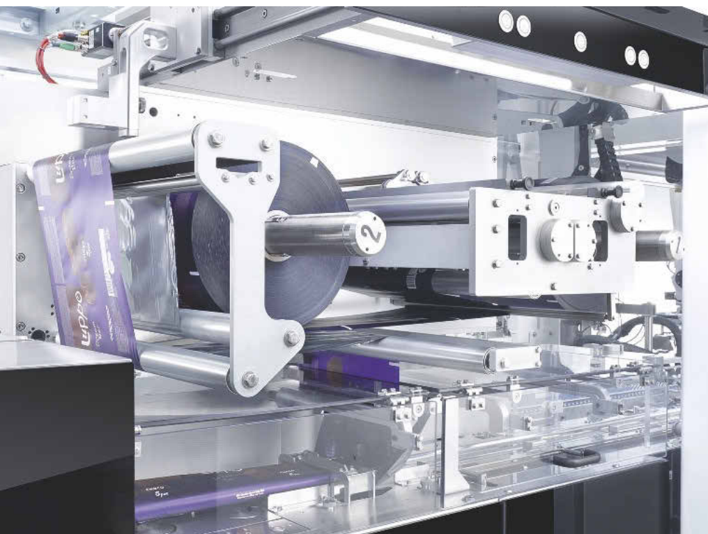
Das Flowmodul von Schubert ist vollständig in die schaltschranklose TLM-Maschine integriert
