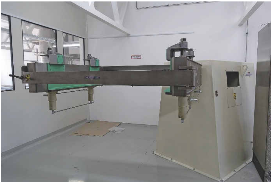
Fest und sicher im Griff: Rahmenkonstruktion mit Aufnahmegabel zum Einspannen der Container
