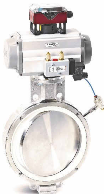
Exzentrisch gelagerte Absperrklappe DKZE 110 APS DZ mit pneumatisch beaufschlagtem auswechselbarem Profildichtring auf leicht demontierbarem Tragring
