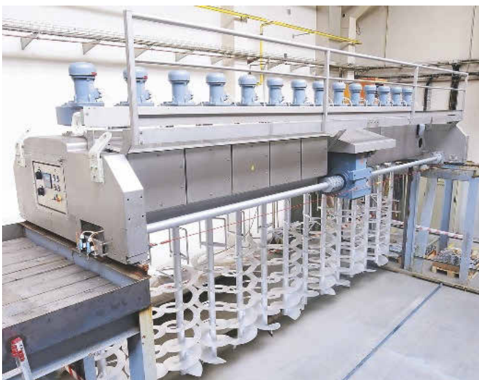
Mopos hat für die tschechische Mälzerei acht Wender modernisiert und mit über 120 Antrieben mit Glattmotoren ausgestattet. Die fertigen Maschinen wurden vorab in den Räumen des Anlagenbauers in Betrieb genommen.
