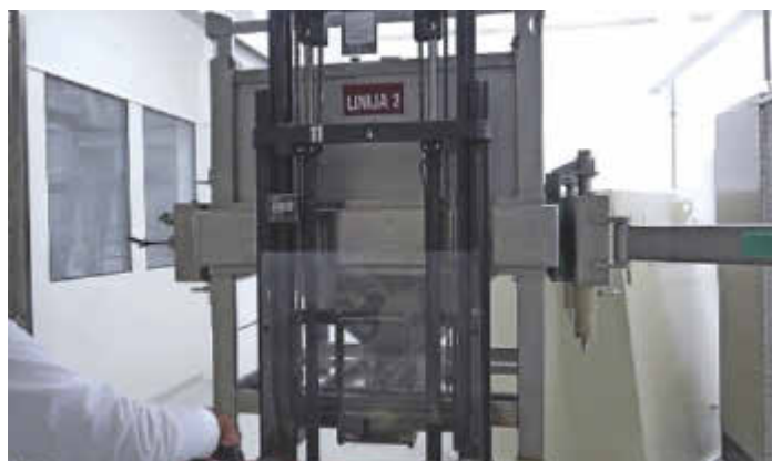
Mithilfe eines Gabelstaplers wird der befüllte Container in die geöffnete Aufnahmegabel gesetzt
