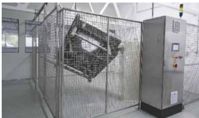
Durch die dreidimensionale Taumelbewegung findet eine optimale Durchmischung der Inhaltsstoffe statt
