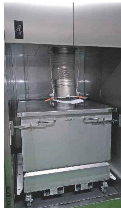
Die Edelstahl-trockenkammer besteht aus vier nebeneinander liegenden Stationen, in die zur Trocknung jeweils ein Container mit Mandeln gefahren wird
