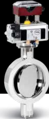
**Schließdichte Absperr- und Regelklappe zum Einklemmen zwischen Flansche nach DIN 24154 (Reihe 2, Teil 2), DIN 2501 sowie ANSI 150 lbs. metallisch dichtend mit zentrisch gelagerter Klappenscheibe.**
