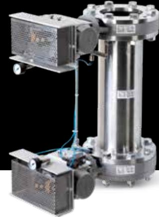
**Doppelklappensystem bestehend aus zwei Absperrklappen der Baureihe DKZ 103 GS, einem Zwischenbehälter und einer EG Baumustergeprüften Ansteuerung (Verriegelung). Sie dienen vorwiegend der explosionstechnischen Entkopplung.**
