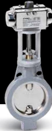
**Schließdichte Absperr- und Regelklappe zum Einklemmen zwischen Flansche nach DIN 2501 und ANSI 150 lbs. – metallisch dichtend – mit zentrisch gelagerter Klappenscheibe.**
