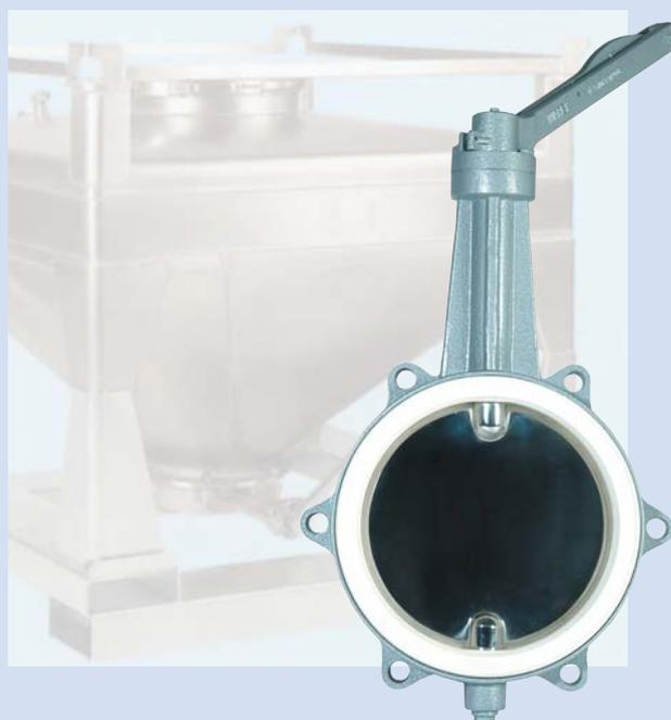
Vanne d'arrêt étanche pour tous milieux, spécialement pour produits solides en vrac, pour montage sur silos ou petits containers (IBC). Commande par levier manuel, joint vulcanisé ou remplaçable.
