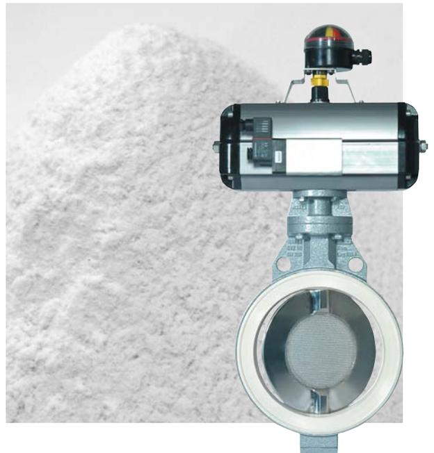
Vanne d'arrêt étanche pour montage entre-bridés suivant DIN 2501 et ANSI 150 avec papillon centré à grille très fine.
