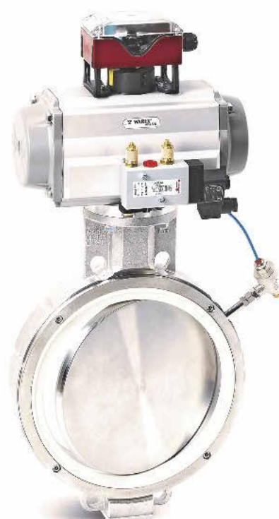
Exzentrisch gelagerte Absperrklappe DKZE 110 APS DZ mit pneumatisch beaufschlagtem austauschbarem Profildichtring auf leicht demontierbarem Tragring
