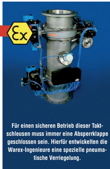
Für einen sicheren Betrieb dieser Taktschleusen muss immer eine Absperrklappe geschlossen sein. Hierfür entwickelten die Warex-Ingenieure eine spezielle pneumatische Verriegelung.
