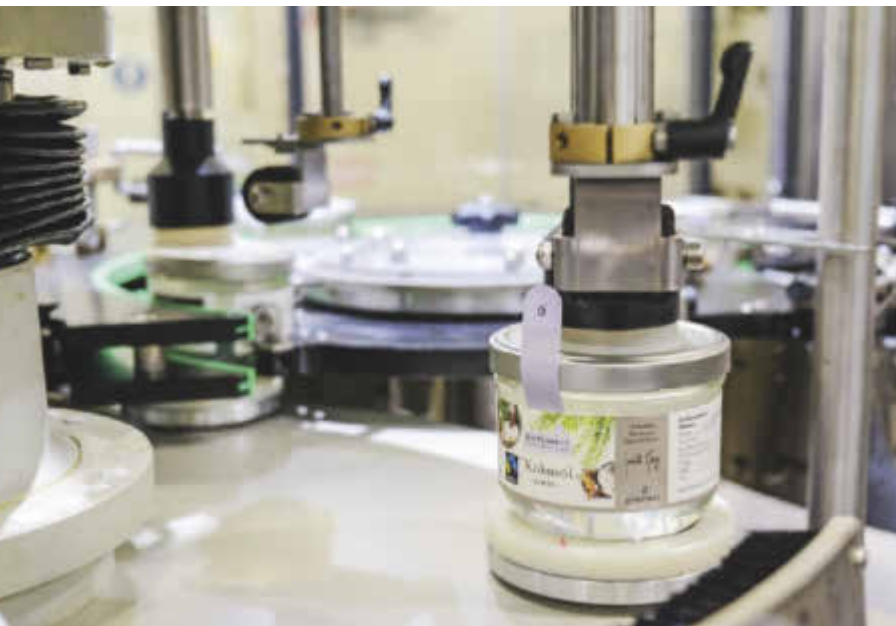
Auf exakten Sitz kommt es an: Das Garantiebänd wird zuerst auf Glas und Deckel appliziert
