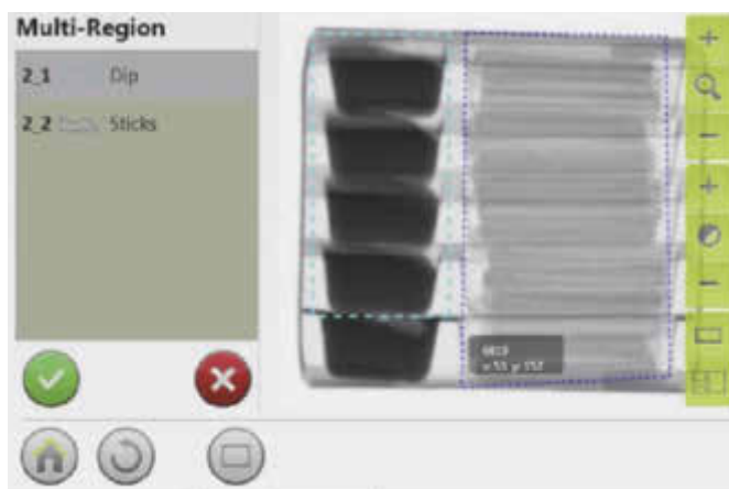
Bei Fertiggerichten erkennt der Zone Analyzer beispielsweise Abweichungen in der Befüllung je Zone
