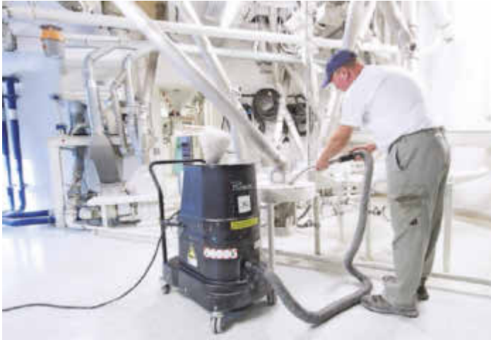
Die Maschinenreinigung gehört zu den Hauptaufgaben von Staub-Ex-Saugern in Mühlenbetrieben
