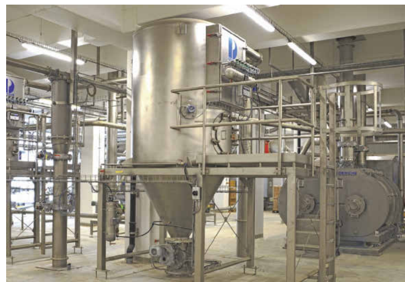
Zur Schüttgutanlage, die Derichs für Milei errichtet hat, gehören auch verschiedene Produktabscheider
