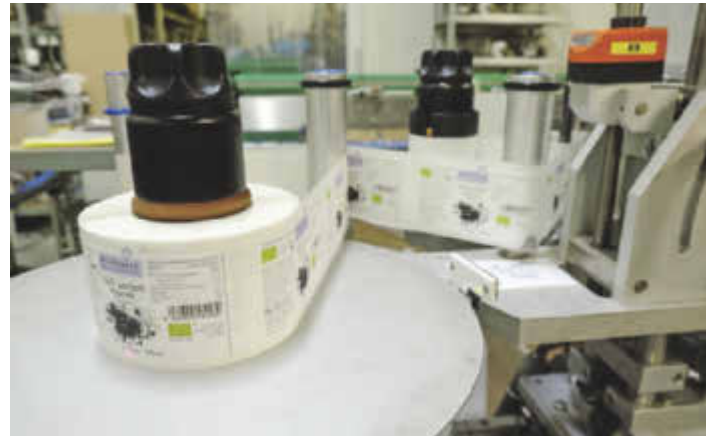
Die Rundläufer-Etikettiermaschine Labetta 6-480 2SK stattet pro Stunde 2000 Flaschen mit partiellen Rundumetiketten aus
