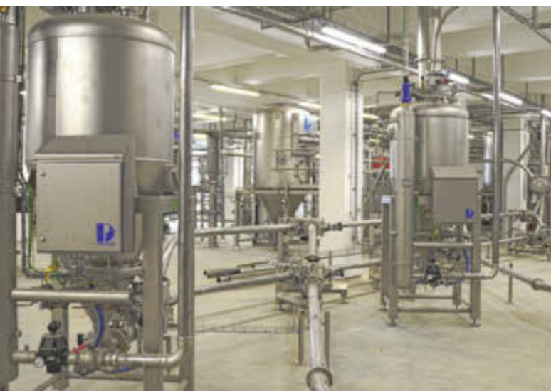
Proteinderivate werden sehr schonend mit Dichtstromförderanlagen transportiert, die mit Sendegefäßen ausgestattet sind
