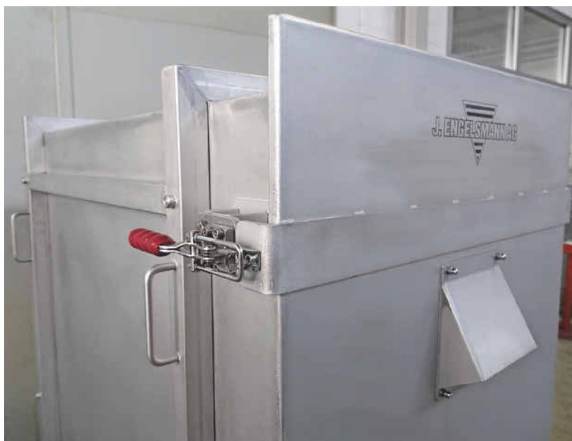
Mithilfe von Spannvorrichtungen und einer durchgängigen Dichtung lässt sich der Einlegerschrank staubdicht verschließen
