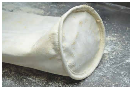
Filterschlauch aus PPS nach zwölf Monaten Standzeit in CIP-gereinigter Filteranlage
