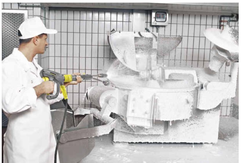
Mit der Pistole Easyforce hat Kärcher das wichtigste Bedienteil des Hochdruckreinigers von Grund auf neu konstruiert. Ihr wesentliches Merkmal ist der Abzug, der mit dem Handballen in den Griff geschoben wird.
