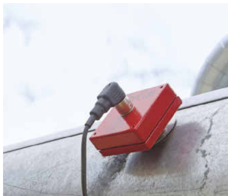
Der Funkenmelder FM1/8 findet seinen Einsatz beispielsweise in Förderleitungen ohne Lichteinfall, die hohe Materialströme transportieren
