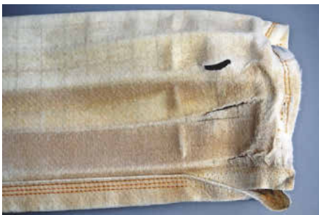
Sekundär mechanisch beschädigter Filterschlauch nach chemischer Vorschädigung
