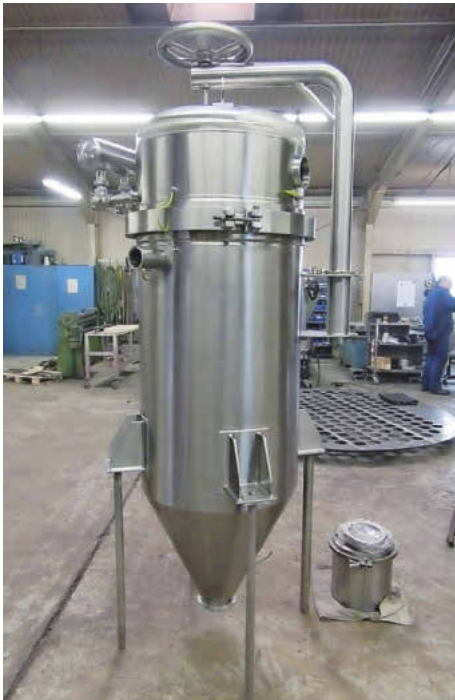
Durch Verwendung von Filtermedien aus beständigeren Werkstoffen lässt sich die Standzeit von CIP-gereinigten Filteranlagen häufig um ein Mehrfaches steigern
